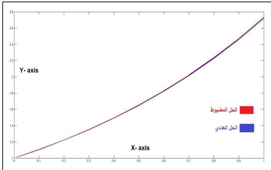
شكل (2) مقارنة بين الحل بتقنية التكامل الرجعي المطورة (1) والحل المضبوط للمسألة (1) عندما قيمة  $h = 0.01$
