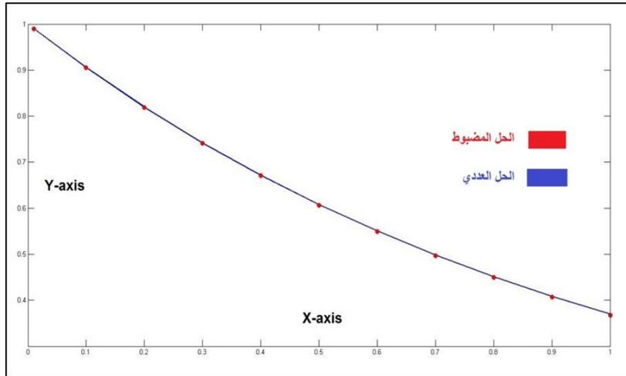
شكل (2-5) مقارنة بين الحل بتقنية التكامل الرجعي المطورة (2) والحل المضبوط للمسألة (2.6) عندما قيمة  $h = 0.01$
