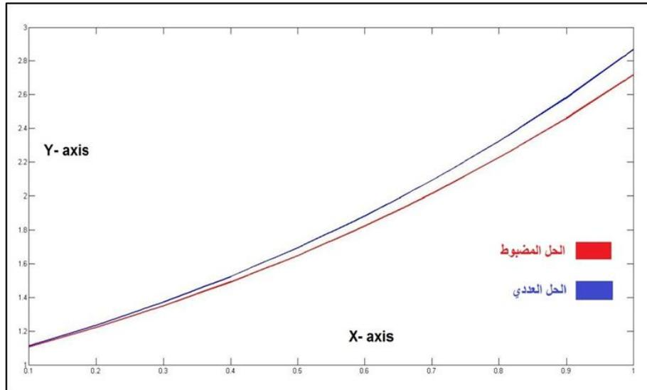
شكل (1) مقارنة بين الحل بتقنية التكامل الرجعي المطورة (1) والحل المضبوط للمسألة (1) عندما قيمة  $h = 0.1$
